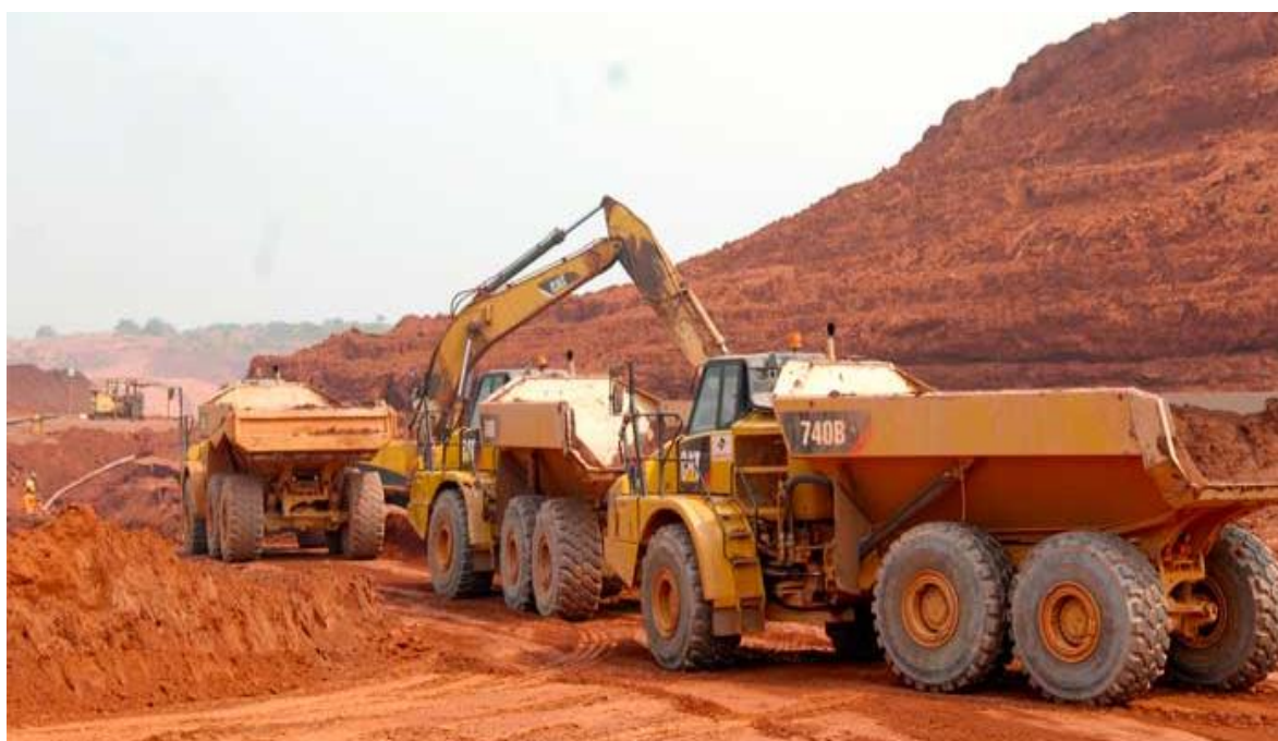
Figura 4.2: Carregamento e transporte do Minério à Lavaria
